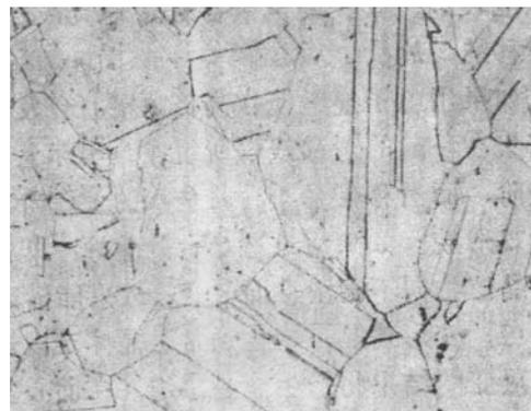
图 7-4 纯铜的退火孪晶
