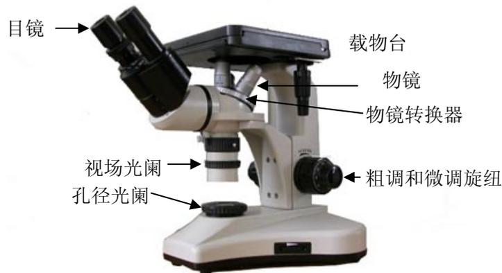
图 1-5 国产 4XB 倒立式金相显微镜
